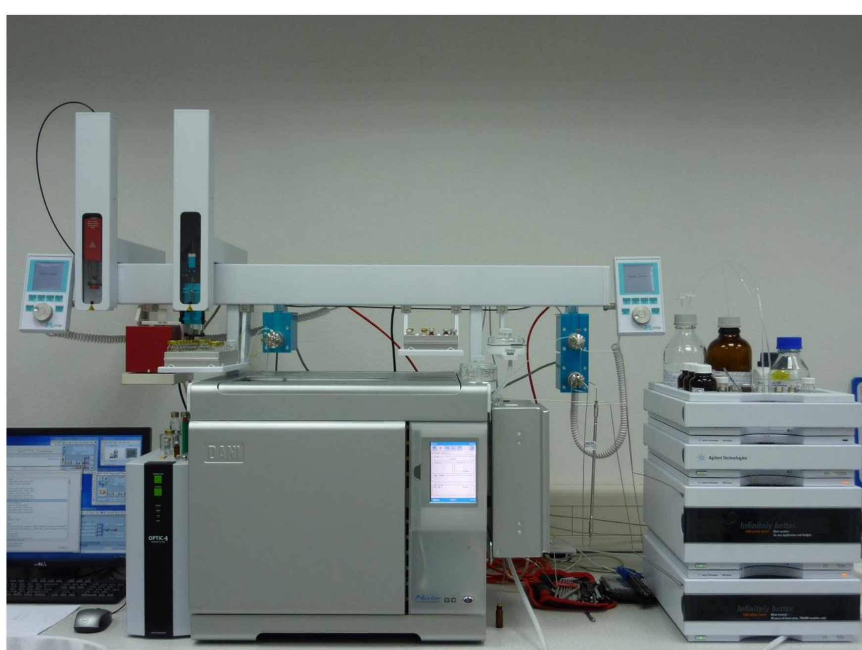
Abb. 1: LC-GC-System bestehend aus Agilent 1260 HPLC mit VWD, DANI MasterGC mit FID sowie CTC DualPAL
